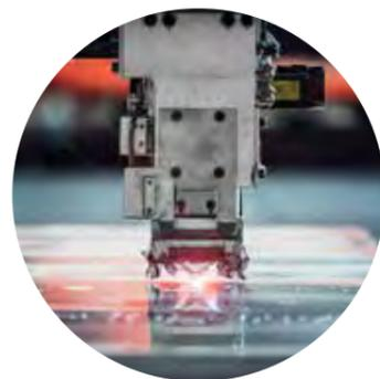
Ces portails sont usinés en surface : une seule tôle compose le vantail et est creusée au laser selon un schéma géométrique bien défini.
