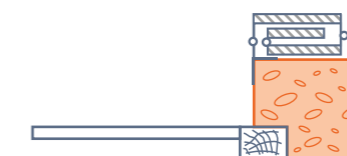
Ferrage sur montants cornière emboîtant l'angle du tableau
